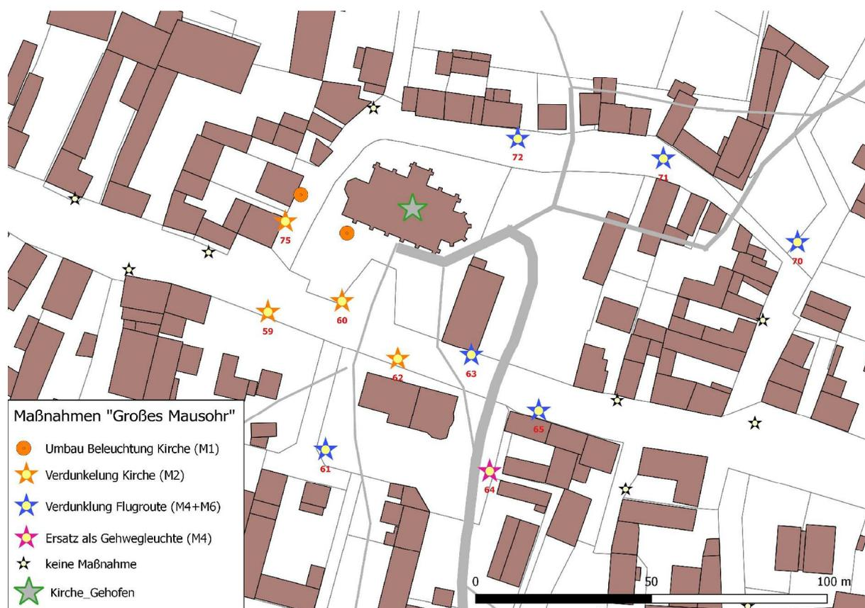
**Abb. 19:** Ausschnitt der Maßnahmenkarte (aus Anlage 03): Eine differenzierte Steuerung der Leuchten in den Flugrouten ist möglich.
